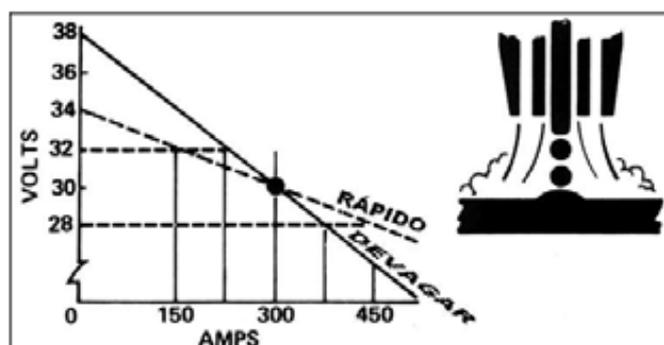
Figura 9 - Influência da velocidade de alimentação do arame
