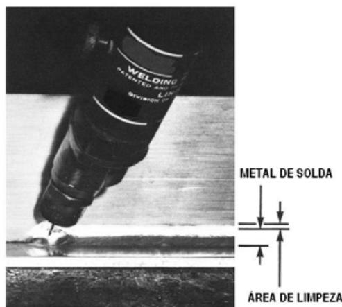
Figura 46 - Técnica de soldagem do alumínio
