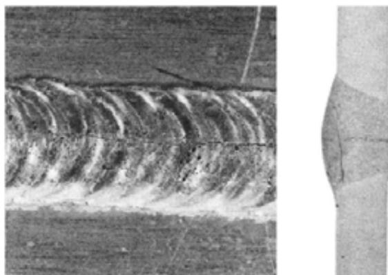
Figura 56 - Exemplo de trinca longitudinal
