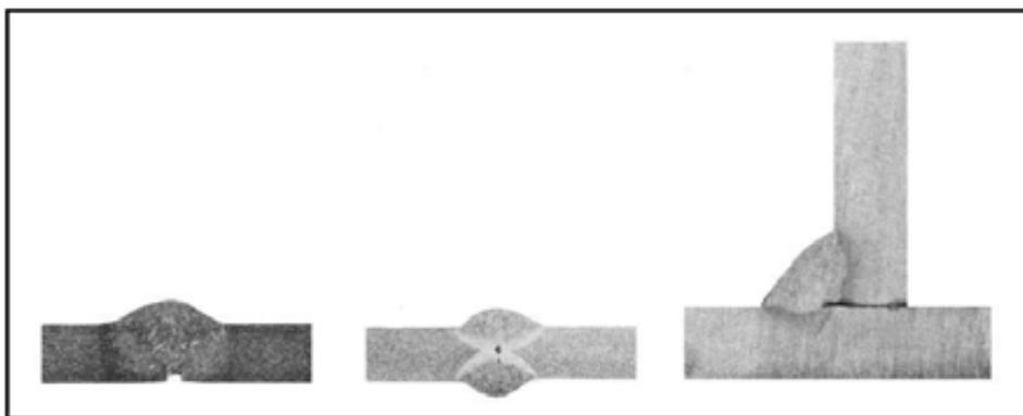
Figura 52 - Exemplos de falta de penetração
