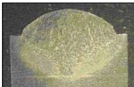
Figura 17 - Perfil *dediforme* obtido na soldagem MAG empregando arame sólido cobreado e uma mistura Ar/CO<sub>2</sub>
