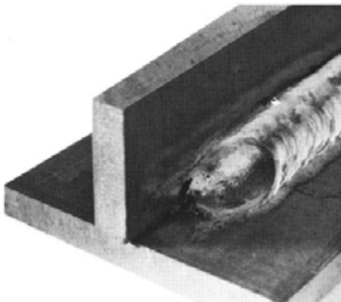
Figura 57 - Exemplo de trinca de cratera
