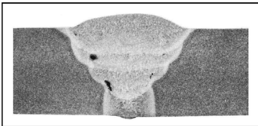
Figura 53 - Exemplo de falta de fusão
