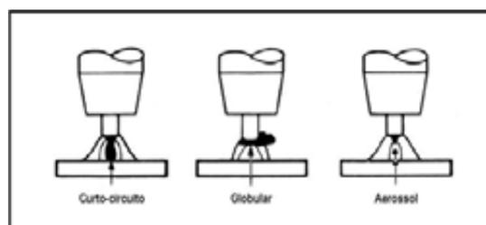
Figura 2 – Modos de transferência do metal de solda
