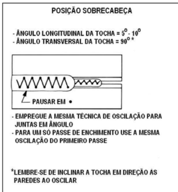
Figura 38 - Manipulações da tocha na posição sobrecabeça
