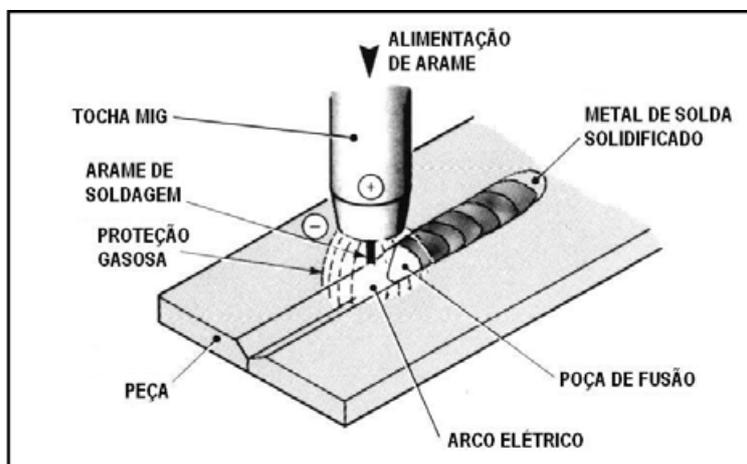
Figura 1 – Processo básico de soldagem MIG/MAG
