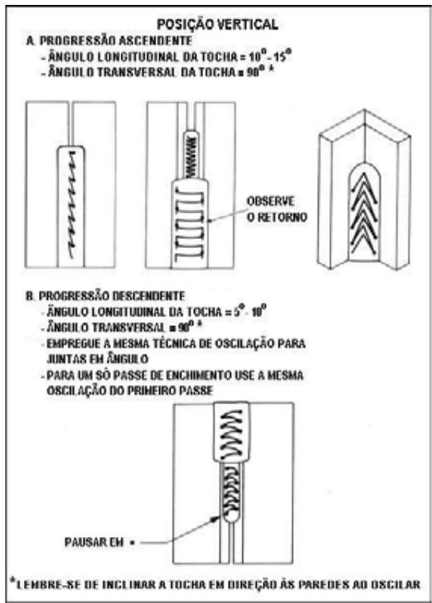
Figura 37 - Manipulações da tocha na posição vertical
