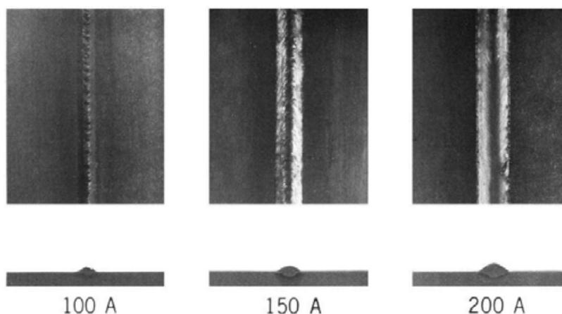
Figura 27 - Efeito da corrente de soldagem na penetração da solda – aço carbono, curto-circuito, Ar-25%CO<sub>2</sub>
