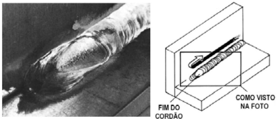
Figura 58 - Técnica de enchimento de trinca de cratera
