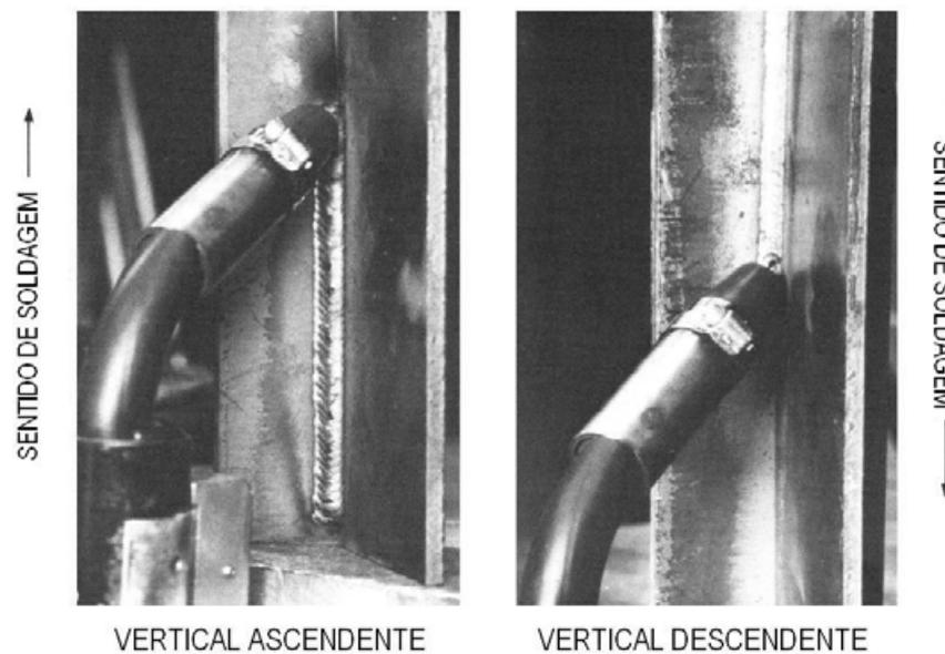
Figura 26 - Soldagem nas progressões ascendente e descendente
