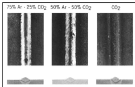
Figura 18 - Efeito de adições de dióxido de carbono (CO<sub>2</sub>) ao argônio (Ar)
