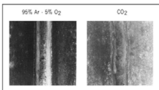
Figura 16 - Comparação entre os gases de proteção 95% Ar/5% O<sub>2</sub> e CO<sub>2</sub>
