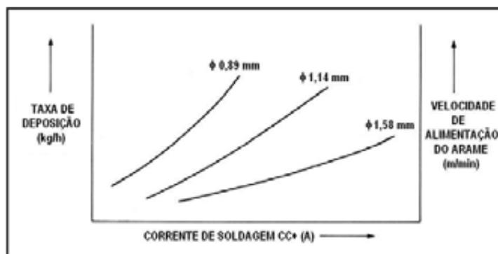
Figura 31 - Taxa de deposição versus corrente de soldagem
